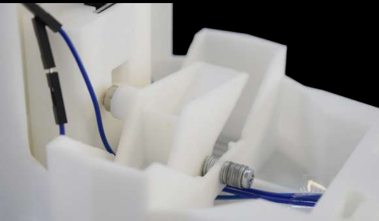
Figura 95. L'interior del pluviòmetre
